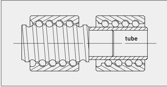
圖4.9 分離螺桿螺帽的正確方式
