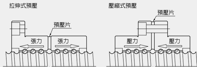
圖4.17 以預壓片尺寸調整預壓方式
