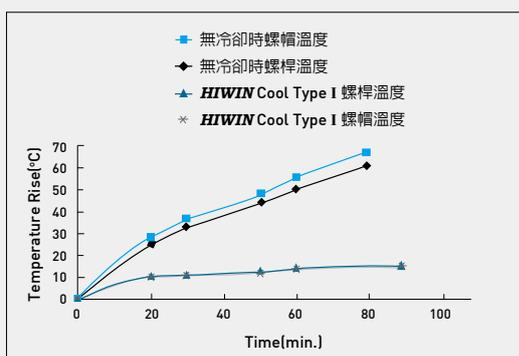
圖8.5 高速運轉下 Cool type I 滾珠螺桿的溫升表現
