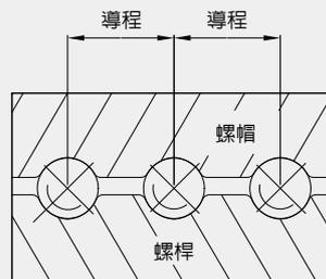
圖 4.18 以鋼珠尺寸調整預壓方式
