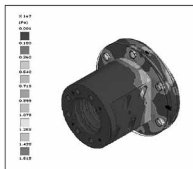
圖8.6 Cool Type滾珠螺桿的有限元素分析
