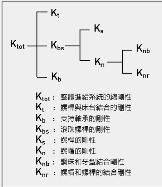
圖 4.28 滾珠螺桿進給系統的架構
