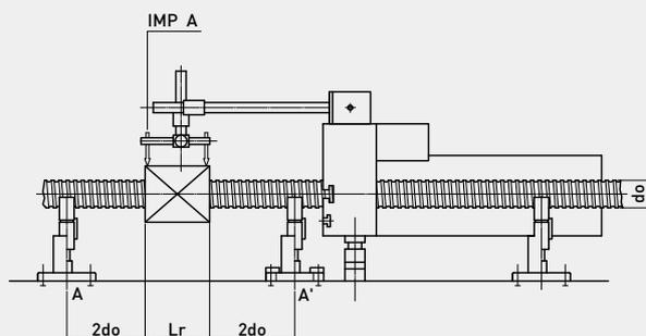
T7: 量測方形螺帽平面相對於AA' 的平行度
