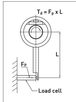
圖 4.20 預壓扭力量測方法(同 JIS B1192)
