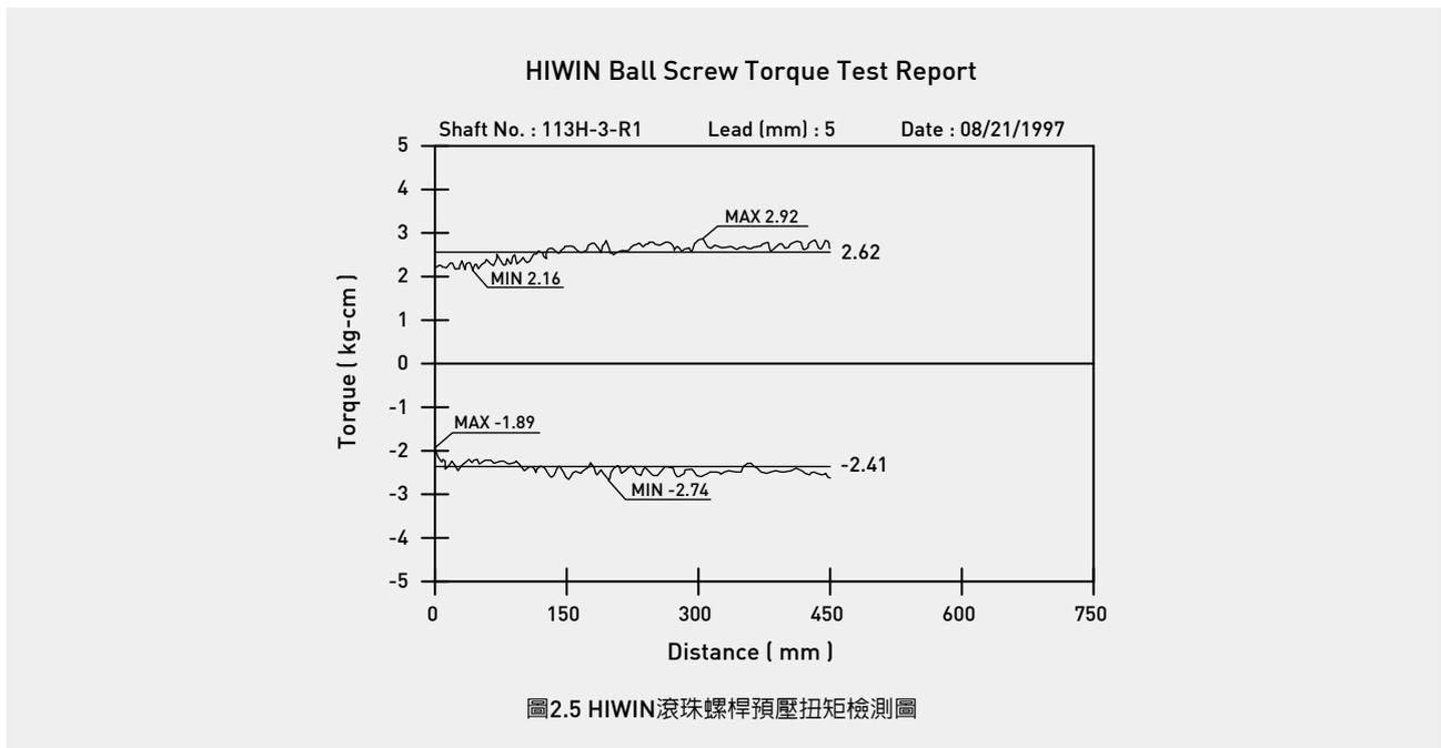
圖2.5 HIWIN滾珠螺桿預壓扭矩檢測圖
