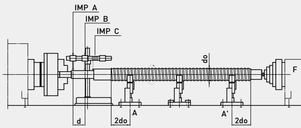
T4: 量測軸承肩部對於螺桿軸AA' 的垂直度
