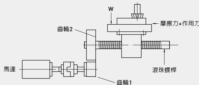
圖 4.23 滾珠螺桿動力傳動系統的說明圖
