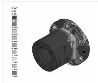
圖8.10 Cool Type滾珠螺桿的有限元素分析
